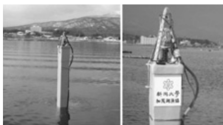
佐渡島加茂湖に設置した水温測定装置
