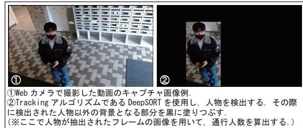
図2 Webカメラ画像からの歩行者検出とマスク処理の方法
