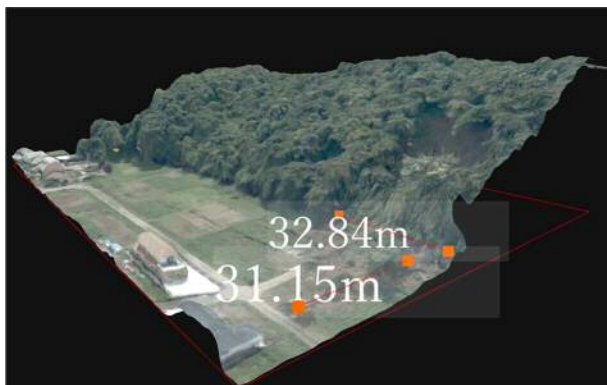
図 4 土砂崩 3D モデル（数値は簡易計測値）
