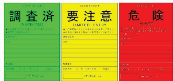
図 7 応急危険度判定のステッカー
