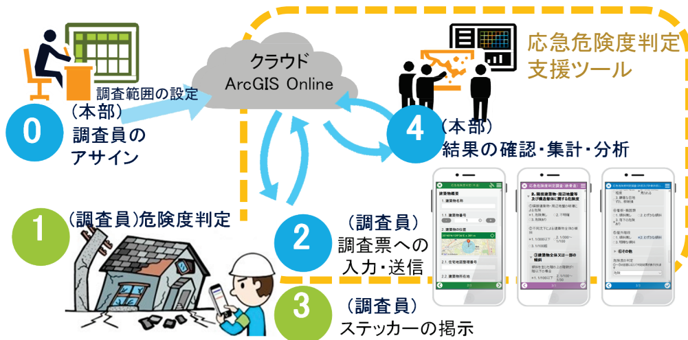
図1 応急危険度判定支援ツールの概要
