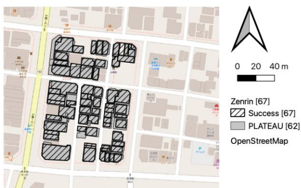
図6 OLC8 桁と重複率 20%によるマッチング結果
