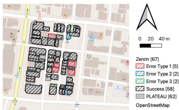
図4 ジオメトリ交点と距離によるマッチング結果
