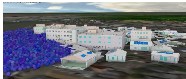
(d) 津波が堤防(高さ3mとしている)を乗り越え, 「動的3次元建物モデル」に接触・破壊し始めた状況
