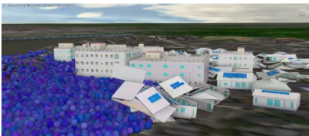
(e) 津波が堤防(高さ3mとしている)を乗り越え, 「動的3次元建物モデル」を破壊し始めた状況
