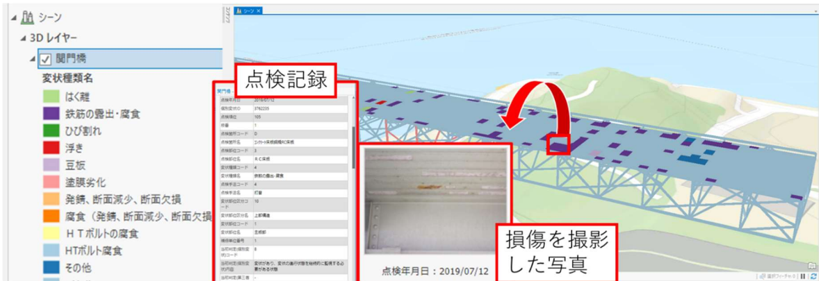
図 10 点検記録を関門橋の3次元モデルに格納した結果
