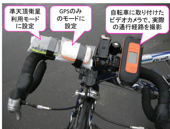
図 1 測位・撮影機材の設置状況
