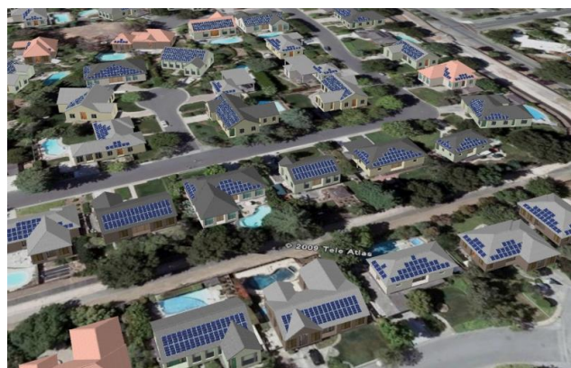
図-10 本システムで自動生成した、屋根にソーラーパネルを配置した米国の住宅街の3次元都市モデル
