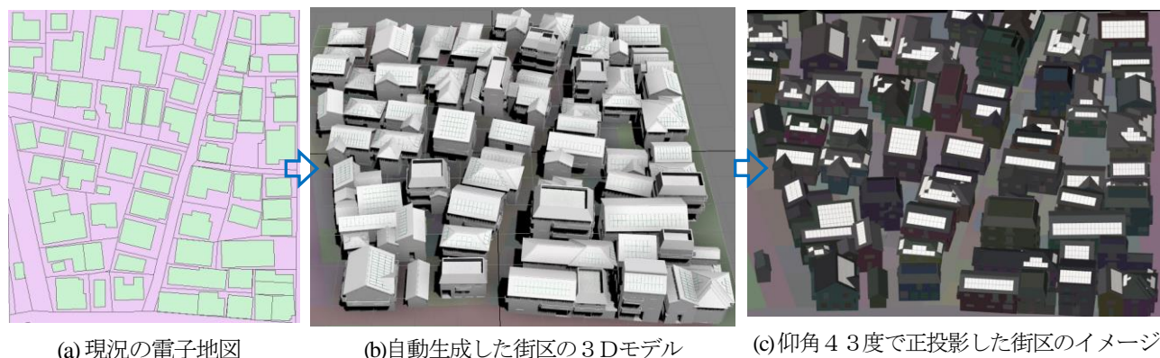
図-2 電子地図から自動生成した街区の3Dモデルと正投影した街区イメージ
