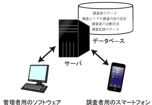
図1: スマートフォンを用いた汎用調査システム
