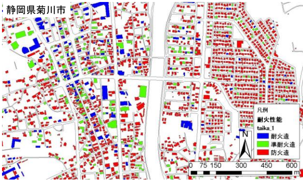
図- 2 本手法による耐火性能推定の結果
