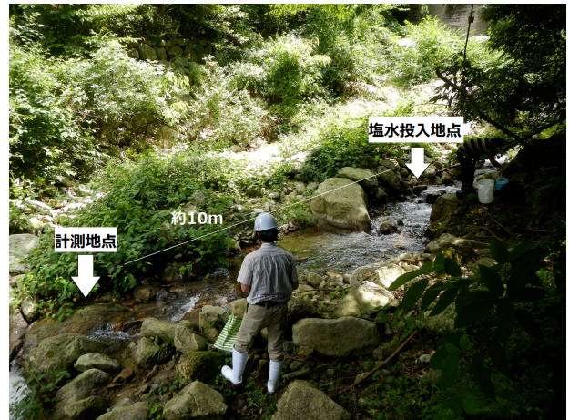
写真-1 塩分希釈法による流量計測
