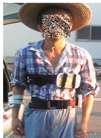
図- 2 センサモジュールや iPhone アプリを用いた予備実験の被験者(医療用ゴムベルト、工業用ベルト等で堅固に固定)
