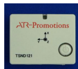
図- 1 利き腕の下部に装着する ATR-Promotions 社製 小型無線多機能センサ(TSND121)
