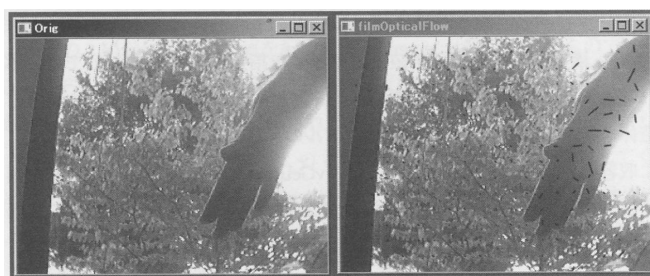
図-6 OpenCVを用いた動作分析実験の一例 (利き手の下部の動作具合が分かる)
