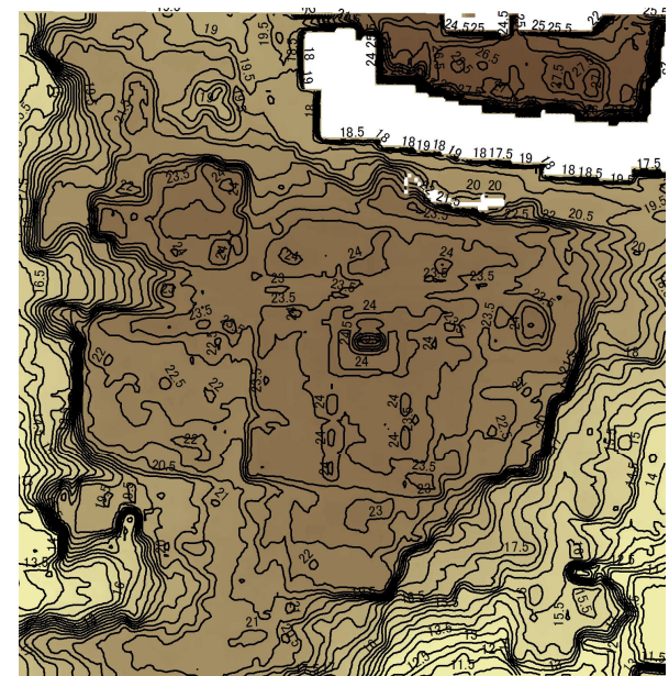
図-3 クリギングによって得られた段丘構成層上面の DEM（上）と、現地形の DEM（下） （上図のポイントを使用し DEM を作成）
