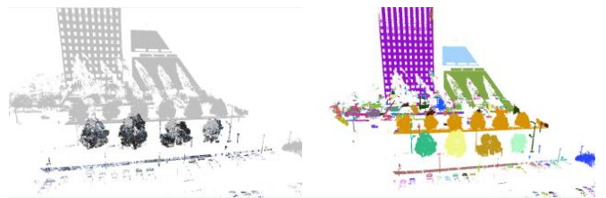
(a) 330 万点の点群 (b) KD-Tree による点群のクラスタリング
