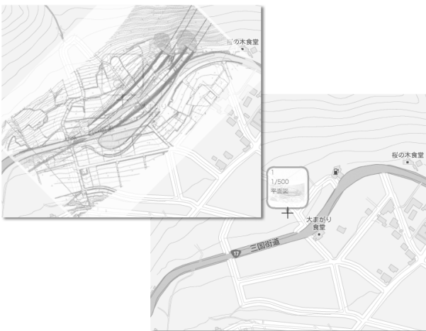
図-3 現地の地図と図面マーカー(右下)と地図上にマッピングされた図面画像(左上)
