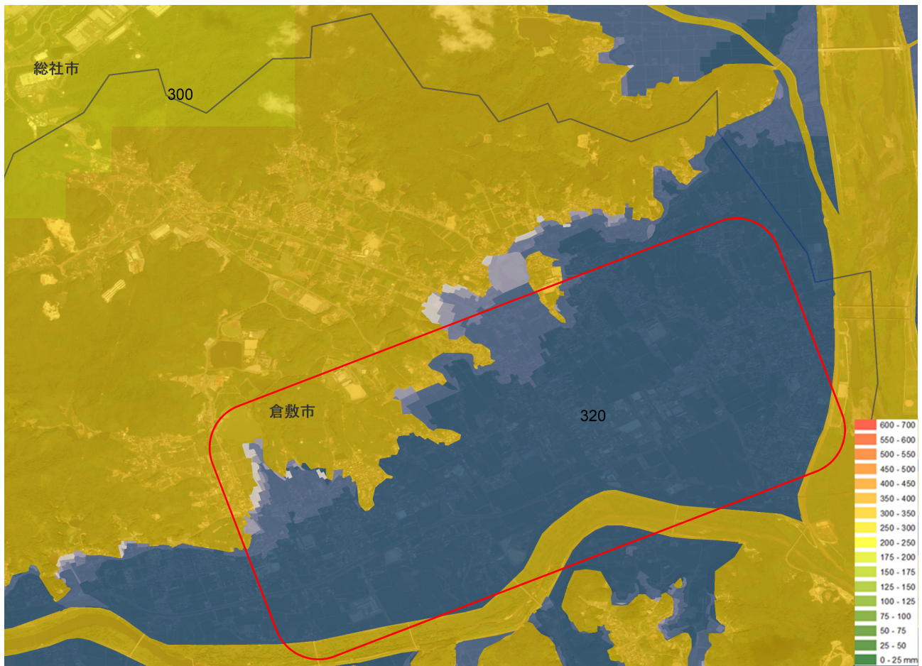
図-8 CX-band MP レーダ雨量 7 月 3 日-8 日 168h 岡山県浸水想定区域図との合成（岡山県倉敷市付近）
