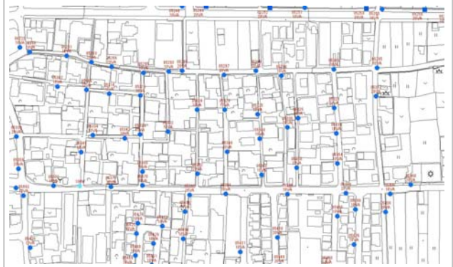
図-3 照明灯管理システムの座標取込機能 (上) と GIS 展開イメージ
