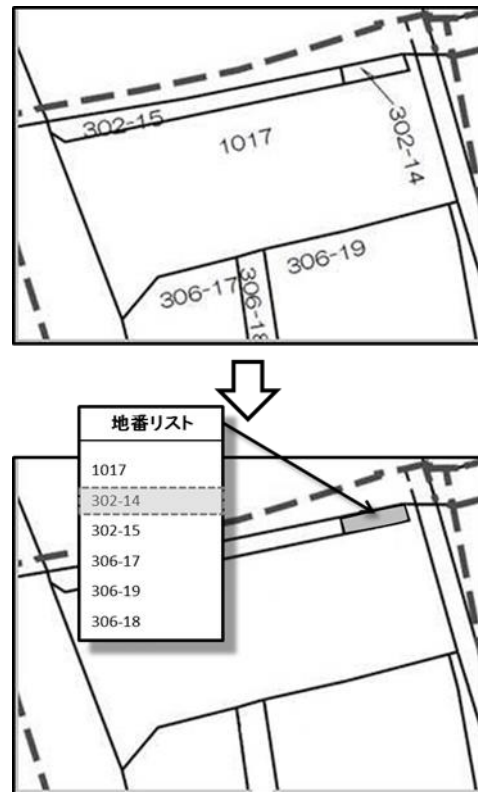
図-1 地図情報の要素間の関連付けの例：地番参考図では、土地区画と地番が関連付けられる。
