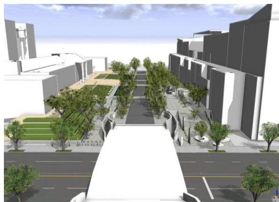
図2 横浜みなとみらい21地区グランモール公園の3D図。周囲の白い建物や橋は別途写真測量で作成されたものである。
