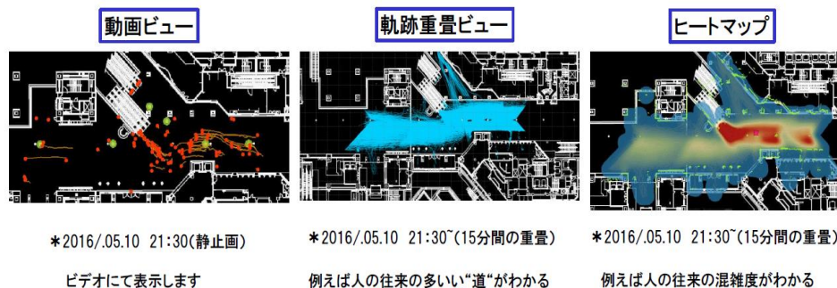
図3 横浜みなとみらい21地区クイーンズスクエアの地上2Fでのレーザーセンサーによる測定(出典;(株)日立情報通信エンジニアリング)
