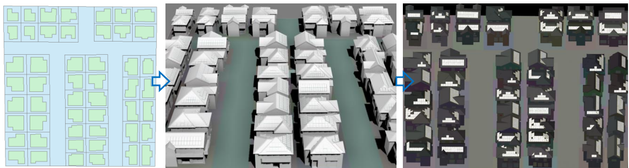
(a)区画整理の電子地図 (b)区画整理した街区の3Dモデル (c)正投影した区画整理した街区イメージ
